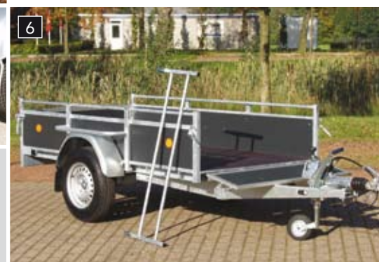
▲ Bindhaken en uitzetsteunmontage plaatjes aangelast
